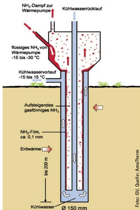
Prinzip einer AZV-Sonde zur Wärme- und Kältegewinnung
