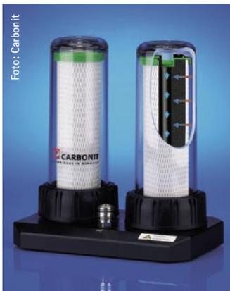
Der Untertisch-Trinkwasserfilter Carbonit DUO Kalk reduziert die Wasserhärte und hält in der zweiten Filterpatrone Bakterien und Schwermetalle zurück
