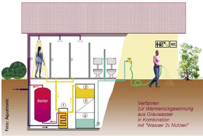
Bild 3 Prinzipbild einer Wärmerückgewinnung aus Grauwasser mit kombinierter Nutzung als Betriebswasser zur Toilettenspülung oder zur Gartenbewässerung [Aquatronic]
