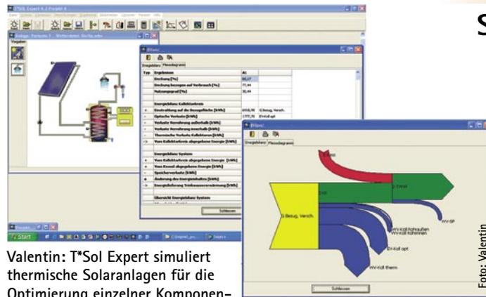
Valentin: T\*SOL Expert simuliert thermische Solaranlagen für die Optimierung einzelner Komponenten und ermöglicht die Planung, Auslegung und Überwachung
