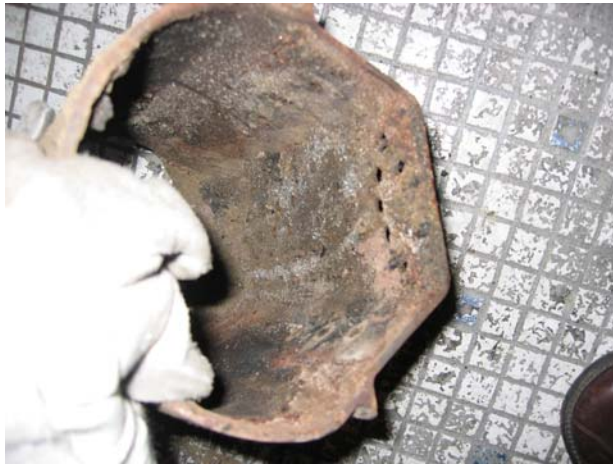
Abb.: Mit Verbrennungsrückständen verstopfte Bohrungen im Brennerhals.
