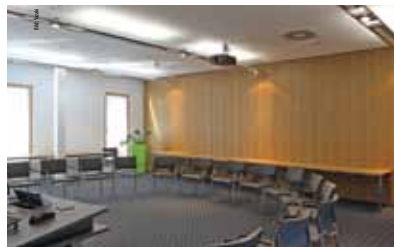
Der 120 Personen fassende Konferenzraum kann rund drei Stunden vor Nutzung zusätzlich über den Fußboden vorgekühlt werden, um Lastspitzen zu vermeiden.
